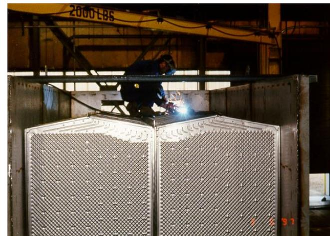
Die Plattenpackungen sind fest mit dem Gehäuse verschweißt. Das Schweißen erfolgt oben und unten.
