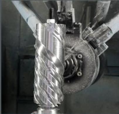
Verdichterschraube für Dampfmotor
