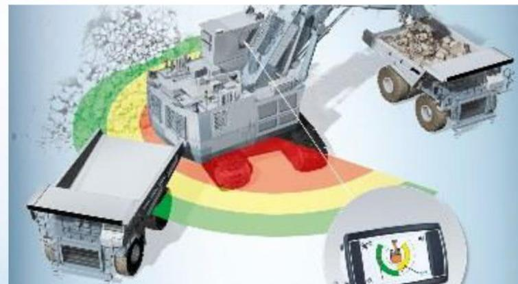
Los dispositivos Minesic o Visionary se montan en vehículos subterráneos. Estos son sistemas de detección de proximidad de alta precisión que monitorean la distancia a los alrededores del túnel e identifican posibles peligros de colisión
