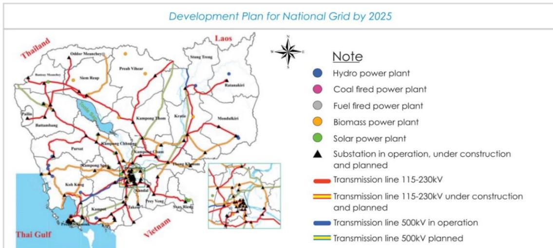
Abbildung 1: Entwicklungsplan des Ministry of Mines and Energy sowie der Electricity Authority Cambodia für das nationale Stromnetz bis 2025
