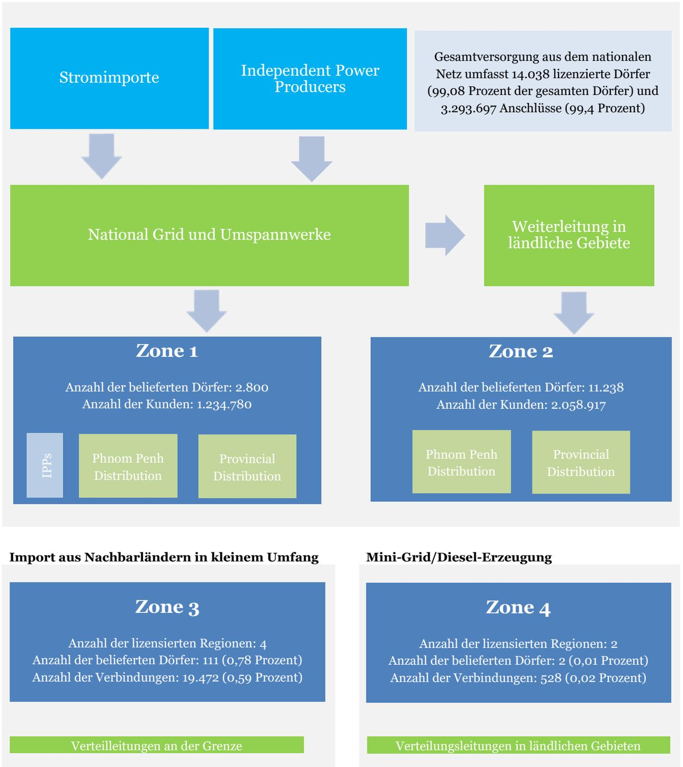
Abbildung 4: Elektrizitätsversorgung in Kambodscha
