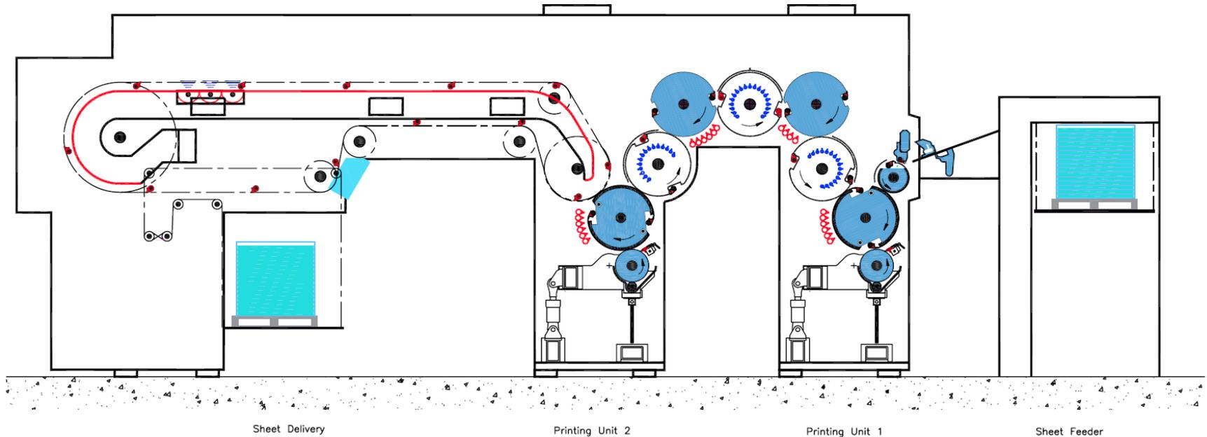
Las secciones de secado todo-en uno con cuchillas de aire de alta velocidad controladas por frecuencia y los cartuchos de calentamiento ajustables, al igual que IR y UV, pueden ser ajustadas para cualquier sustrato y grosor de película de tinta para mayores ahorros eficientes de energía.
