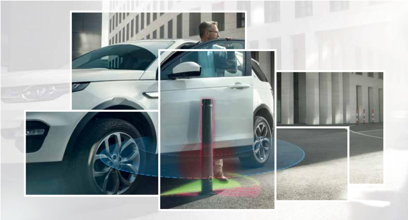
Der sensorgesteuerte Kollisionsschutz des elektrischen Seitentürantriebs von Brose schützt Mensch, Fahrzeug und Umgebung.
