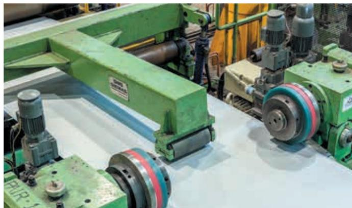
Цель модернизации – повышение пропускной способности линии за счет повышения работоспособности кромкообрезных ножниц и повышение качества кромки полосы. В частности, кромка и равномерность краев улучшается на мягких материалах.
